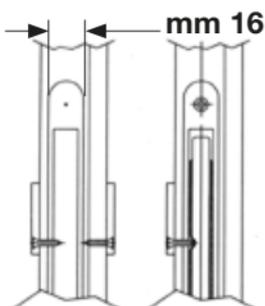
Verificare che lo scasso della serratura sia libero da corpi estranei e che non ci siano viti che possano arrivare alla serratura
