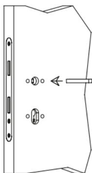
Posizionare il perno quadro maniglia nel foro superiore della serratura
