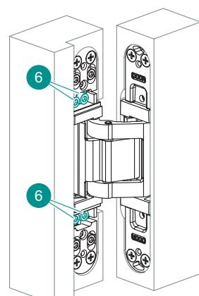
**□ Andruckverstellung / Depth adjustment /
